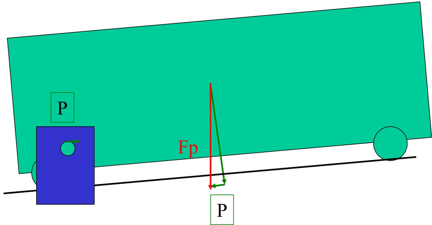
Если ворота установлены не строго горизонтально, то приводу необходимо преодолеть не только силу трения качения но и также силу, создаваемую весом створки  $P$ .
